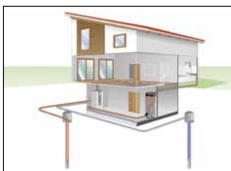
L'eau : Puits d'aspiration et puits de rejet
